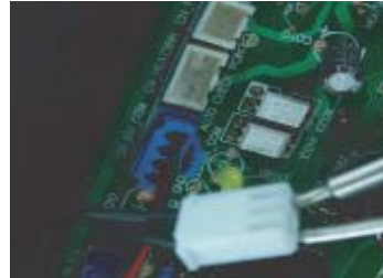
Sıcaklık sensörü kablo çıkmlarını kontrol etme
