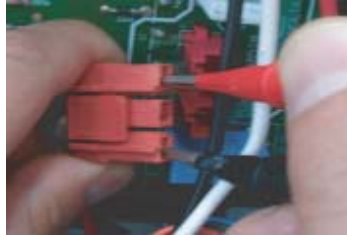
Fan motoru faz direncinin ölçülmesi
