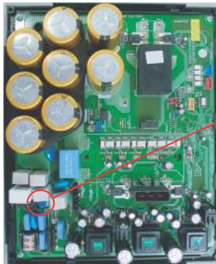
* İnvertör PCB grubu kablo bağlantıları
