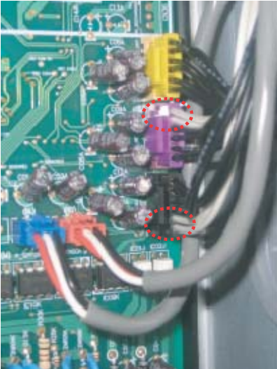
İnvertör kompresörü deşarj sıcaklığı sensörünün direncini kontrol edin
